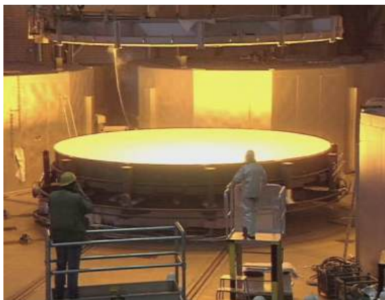
Abbildung 3.3.1: 8.2m Hauptspiegel des Very Large Teleskope (VLT) in Chile, 1993 beim sog. casting (Abgiessen) (ESO)
