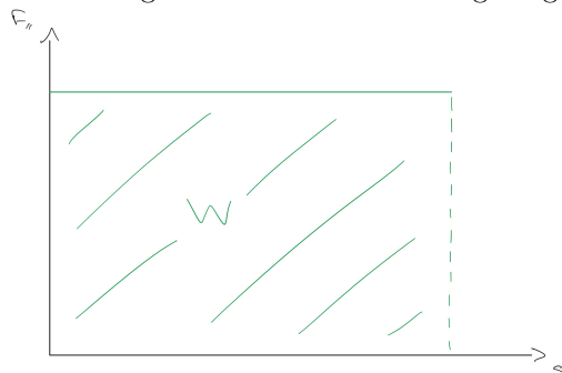
Skizze 5.19: Kraft-Weg-Diagramm (mit konstanter Kraft F_{\parallel} )
